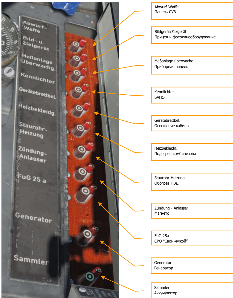
Рисунок 77: Описание АЗС передней панели
