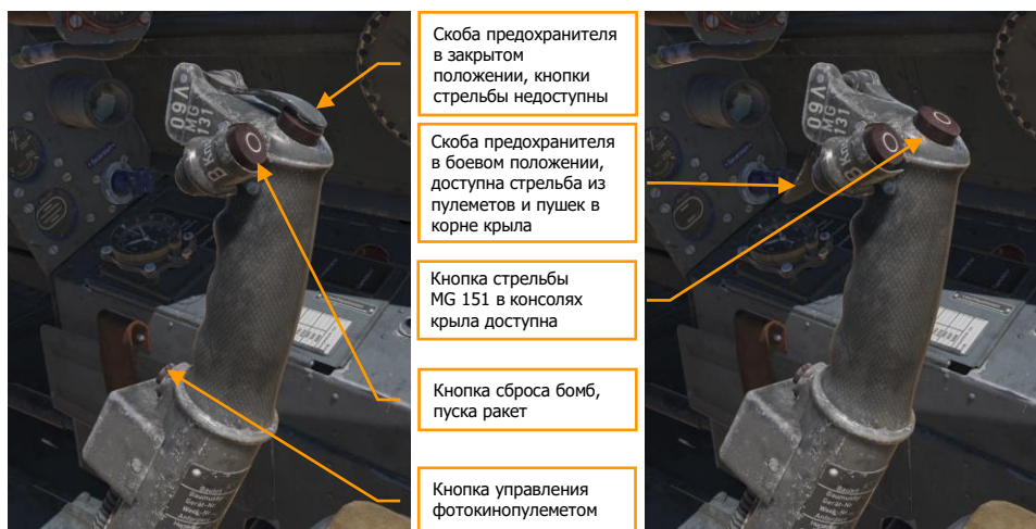
Рисунок 81: РУС, расположение управления вооружением и фотокинопулеметом, предохранитель закрыт (слева), предохранитель открыт (справа)
