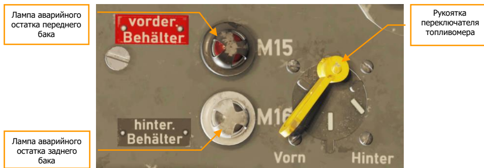
Рисунок 53: Лампы аварийного остатка топлива и переключатель топливомера
